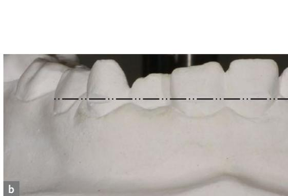
Abb. 7a und b Mit einem Skalpell wird in Höhe der Papillen eine v-förmige Vertiefung an den labialen Flächen der Eck- und Schneidezähne (nur im Unterkiefer) eingearbeitet. Beim Einsetzen des Funktionsreglers werden die Zähne am Patienten *nicht* eingeschliffen (a)! Spätere Lage des Labialdrahtes (b).
