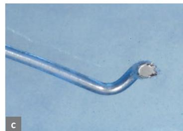
**Abb. 29a bis c** Der Anteil des seitlichen Verbindungsdrahtes, der im Wachsfutter steckt, ragt jetzt aus dem Kunststoff heraus (a). Abschleifen und Glätten des Drahtendes (b und c).
